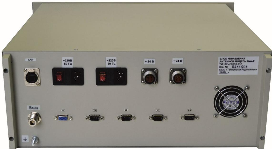
Рисунок 1.2.4.2 – Внешний вид БУА-Т со стороны задней панели изделия
